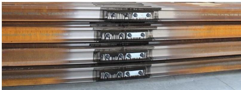
FIGURA 6 GIUNTI ISOLANTI INCOLLATI
