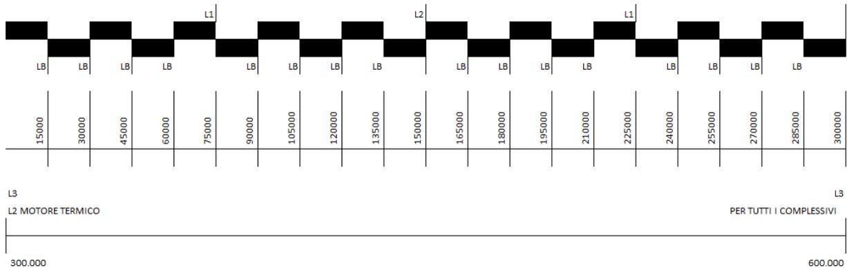
**Figura 1: Manutenzione programmata chilometrica delle automotrici Diesel-Elettriche Rimorciate**
