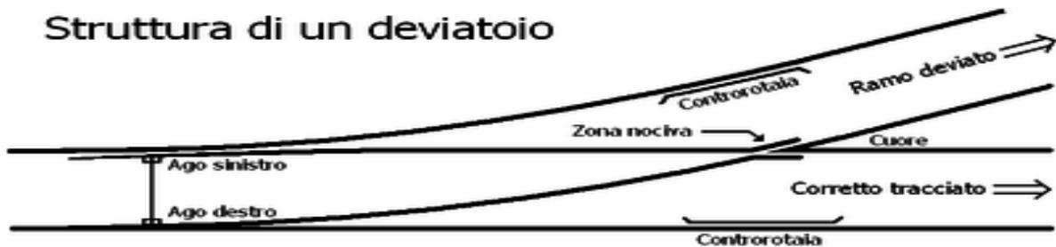
Figura 1: Struttura del Deviatoio
