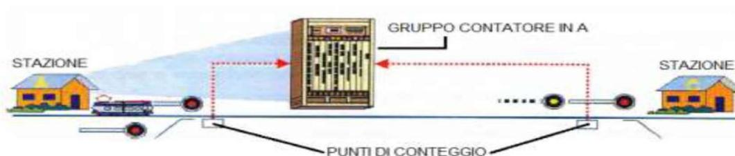
*Figura 2: Schema di Apparato Bca generico*
