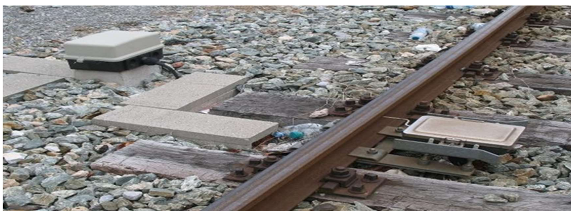
Figura 7: Pedale SILEC a braccetti
