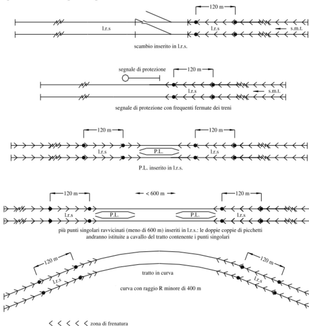
Figura 31: traguardi inseriti nel corpo della LRS in corrispondenza di zone di frequente frenatura
